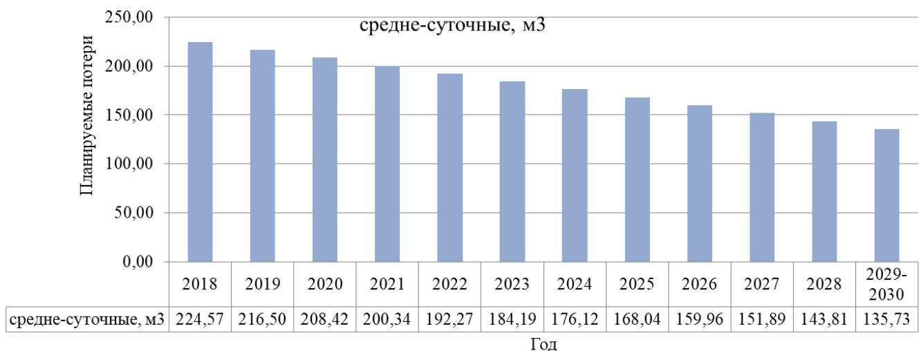
Рисунок 25 – Фактические и планируемые потери горячей воды при ее транспортировке
